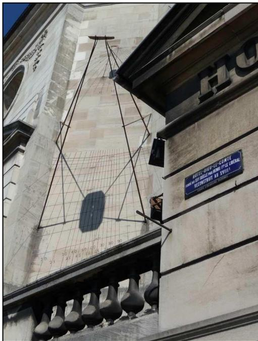
A mon arrivée à 12 h 31, 20 minutes avant le midi solaire vrai, la tache lumineuse centrale se trouve bien sur la droite équinoxiale du grand cadran et sur la ligne horaire 11 h 40 ; ouf ! Premières photos... Malheureusement, le cadran supérieur est en retard d'une quinzaine de minutes à cause de la mauvaise position actuelle de son œillette.
