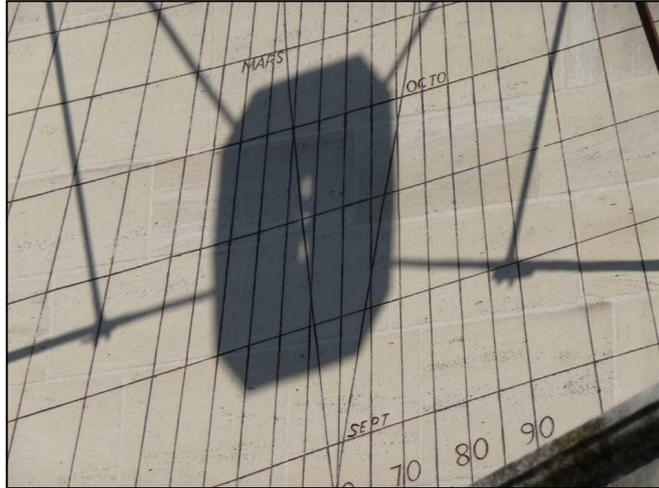
12 h 44, la tache centrale est à l'intersection de l'équinoxiale et de la courbe en huit de midi moyen à l'instant même de l'équinoxe de printemps !
