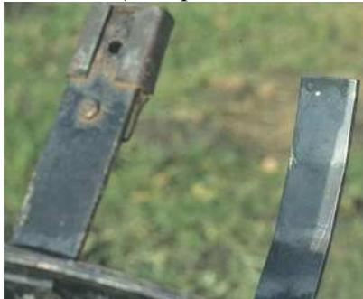
Dans le haut de la branche "2a" est enchâssée une lentille qui focalise l'image du Soleil, sous forme d'une petite tache lumineuse, sur la branche "2b" où est gravée la courbe en 8, représentative de l'équation du temps.
